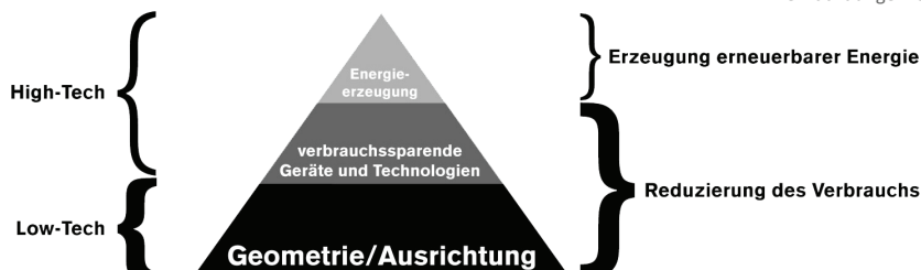
Reduzierung CO2: Wirksamkeit baulich. + techn. Maßnahmen zur Reduktion von Energieverbrauch/ Gewinn erneuerbarer Energie
